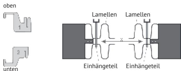
Mit der typenspezifischen Maßtabelle erhalten Sie stets die richtige Positionierung für die U-Schienen und die Halter zum korrekten Einhängen und Fixieren des Heizgeräts.
