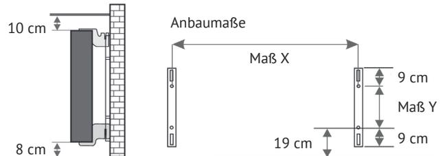
Alle Heizgeräte besitzen vier temperaturbeständige Halter, die eine optimale Fixierung des Heizgeräts gewährleisten. Beachten Sie bitte die richtige Einhängeposition der oberen (Markierung 1) und unteren (Markierung 2) Halter am Heizgerät.
