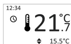
El primer menú que aparece tras la conexión del panel de calefacción AeroFlow®. Presenta la hora actual arriba a la izquierda (configuración, véase la pág. 14). El valor grande en la pantalla al lado del ícono de termómetro presenta la temperatura actual del ambiente. La temperatura pequeña en el ángulo derecho inferior significa la temperatura requerida.
