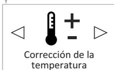
Este ítem del menú se puede usar para la corrección de la temperatura medida. Si la temperatura medida en el recinto por el sensor incorporado del panel calefactor AeroFlow® se desvía de la temperatura real del ambiente, es posible configurar el valor de la compensación.
