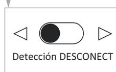
Conecte o desconecte la detección de la ventana abierta. Si se detecta la ventana abierta, con la detección conectada de la ventana abierta, el panel calefactor AeroFlow® se desconecta por un momento.
