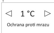
Seleccione la temperatura de protección de la helada entre 0°C y 17°C. Confirme por medio del botón OK. La temperatura de protección de heladas se puede cambiar manualmente en cualquier momento en la pantalla del
