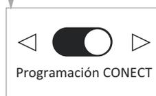
Por medio de los botones con flechas conecte o desconecte el modo de programación. Cuando el modo de programación está desactivado, el menú "Configurar el tiempo de la calefacción" no es visible. Puede reducir o aumentar la temperatura a mano por medio de botones con flechas en el menú "Pantalla de estado" (véase la página 10).
